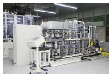
ワニス硬化装置外観（撮影のため安全カバーなどを外した装置外観）
